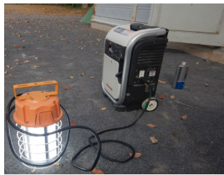
ガス式発電機
